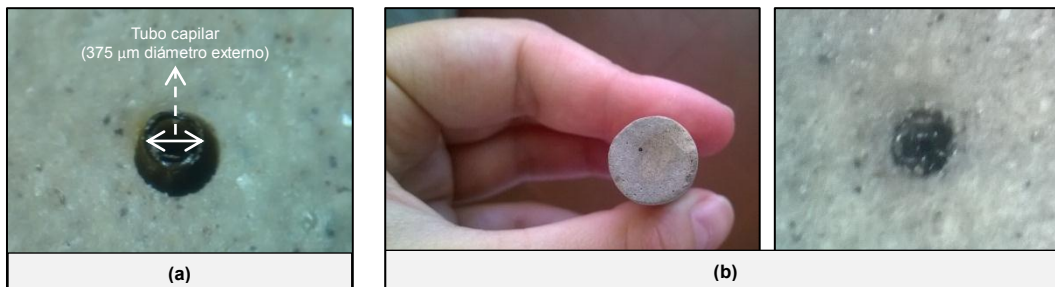
Figura 4.9. Fotografía de la pieza de arcilla gres de alta temperatura. (a) Ensayos iniciales, orificio de diámetro mayor que el diámetro externo del capilar (375 \mu\text{m} ). (b) Pieza de arcilla final, orificio de igual diámetro que el externo del capilar.
