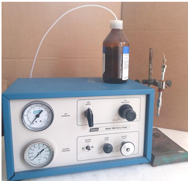
Figura 3.3. Fotografía del sistema de llenado de columnas capilares a alta presión Alltech modelo 1666.
