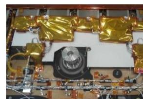
Además, se realizó la integración eléctrica de las mismas, es decir, se conectaron las puestas a tierra de las 600 *MLI* que cubren el SAOCOM, por medio de cables a la estructura.
