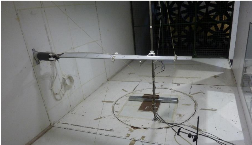
Fig 2. Pala montada en túnel de viento.
