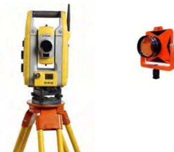
Figura 1: Estación total (izquierda) y prisma reflector (derecha).
