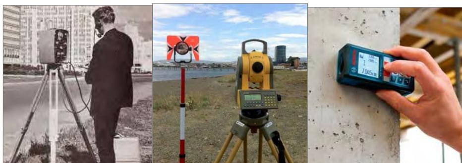
Figura 1: A la izquierda antiguo distanciómetro, en medio una estación total con su reflector y a la derecha un distanciómetro de mano.
