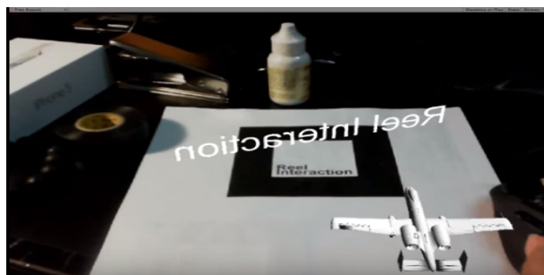
Figura 2.10: NyARToolkit: Ejemplo de uso no comercial en conjunto con Unity utilizando un marcador
