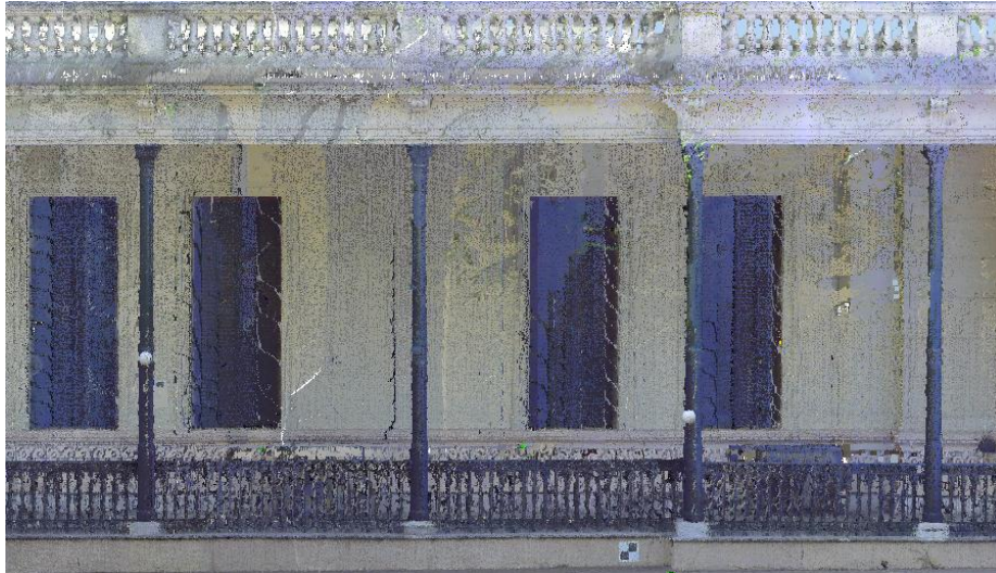
Figura 3-30: Zoom de la zona de la galería de la nube de puntos resultante de la fachada de rumbo SO del Edificio Central de la Facultad de Ingeniería.
