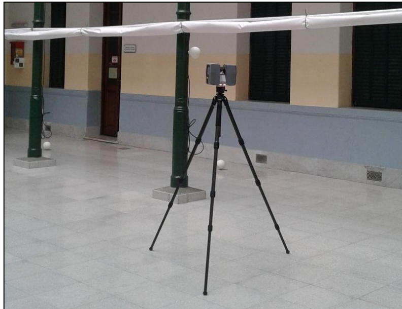
Figura 3-10 Fotografía del escáner láser 3D marca Trimble modelo TX5 durante el relevamiento del patio interior del Edificio Central de la Facultad de Ingeniería.
