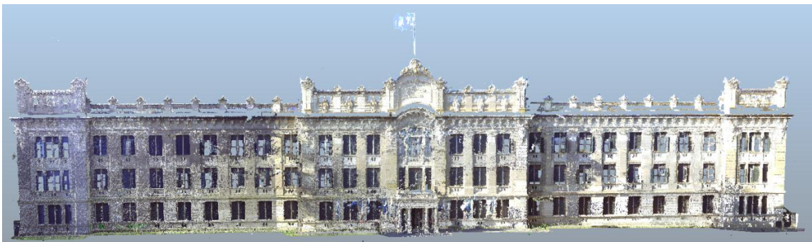
Figura 3-32: Modelo Digital 3D georreferenciado y texturizado de la fachada de rumbo SO del Colegio Nacional.
