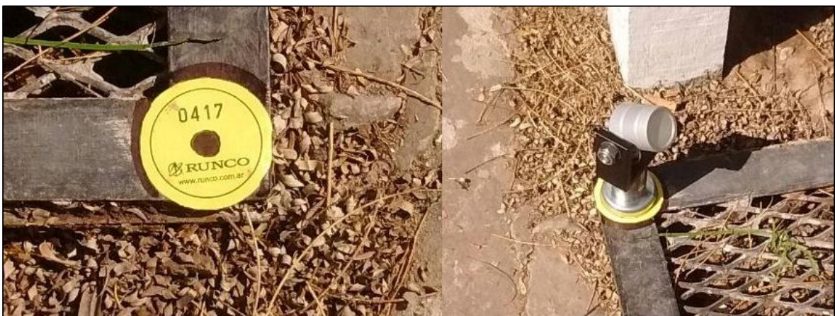
Figura 3-18 . Izquierda: fotografía del modelo de stiker utilizado que marca la posición de una esfera. Derecha: fotografía del mini-prisma ubicado sobre el stiker para conseguir las coordenadas del punto central de la esfera que ocupó ese lugar.
