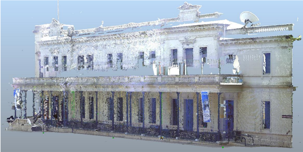
Figura 3-28: Modelo Digital 3D georreferenciado y texturizado de la fachada de rumbo SO del Edificio Central de la Facultad de Ingeniería desde otro punto de vista.
