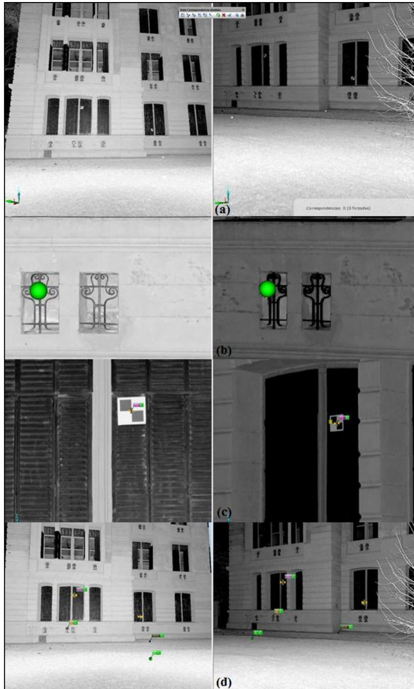
Figura 3-26: (a): Vista de correspondencia dividida con los escaneos de las estaciones E1 y E2 del relevamiento del Colegio Nacional. (b): Identificación de esferas correspondientes. (c): Identificación de tableros cuadrículados correspondientes. (d): Vista de correspondencia dividida con los escaneos de las estaciones E1 y E2 del relevamiento del Colegio Nacional con todos los objetos de referencia asimilables identificados.
