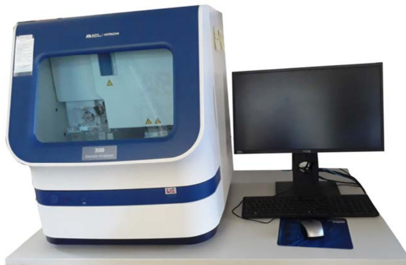
Figura 12. Secuenciador Genetic Analyzer ABI 3500 (Applied Biosystem, USA). Utilizado para las reacciones de secuenciación.
