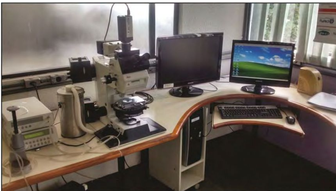
Fig. 1-5. Microscopio Leica® con luz infrarroja transmitida, platina Linkam para ensayo de inclusiones fluidas, su correspondiente equipo controlador de temperatura y dispensador de nitrógeno líquido.
