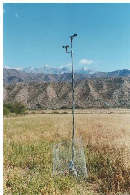
Figura 3. Anemómetro de referencia y veleta.
