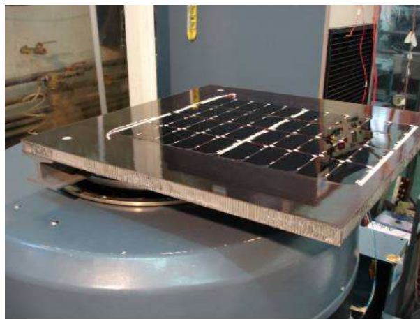
Figura 4. Montaje del panel en la base vibratoria para el ensayo de vibración cantilever .
