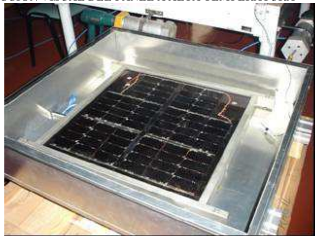
Figura 8. Cámara para inspección visual a 70°C
