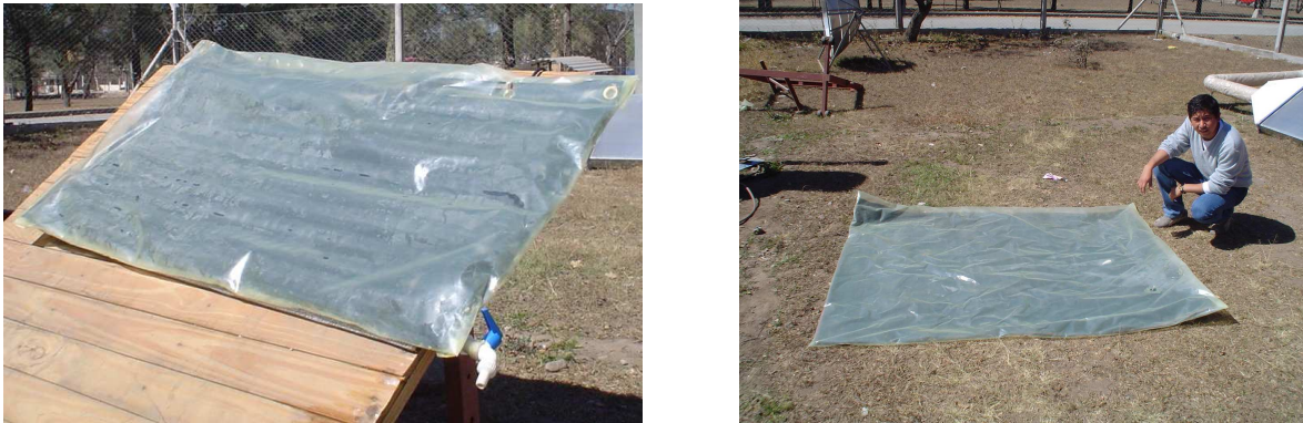
Figura 4: Equipos terminados. A la izquierda el colector acumulador de hasta 10 litros y a la derecha el de hasta 300 litros.
