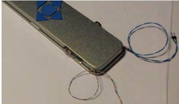
**Fig. 5.10.:** Agregado de motores tipo ERM a los lados de la maqueta para intentar generar el feedback vibro-táctil buscado
