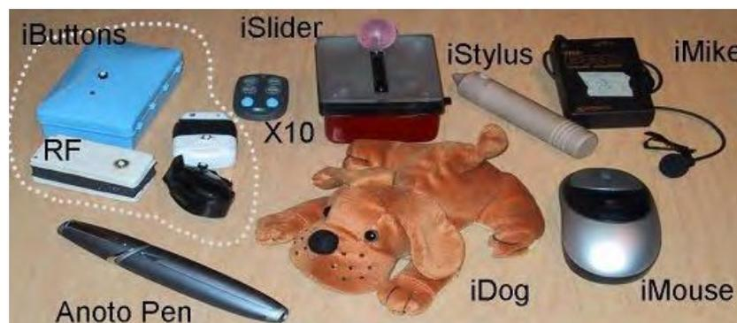
**Fig. 3.13.:** Componentes de input en iStuff, de <https://hci.stanford.edu/research/istuff/>
