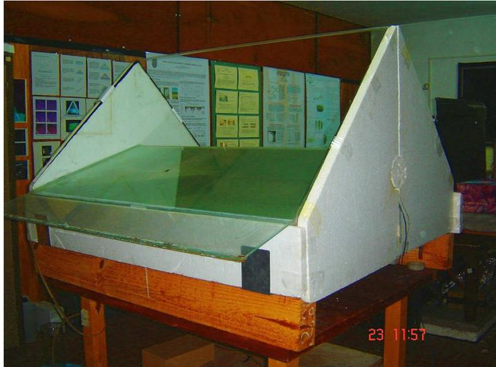
Figura 1. Destilador empleado en laboratorio.
