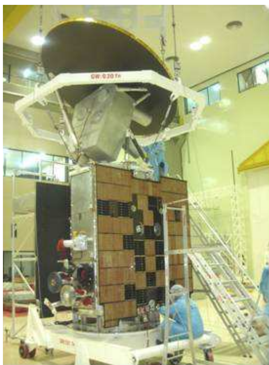
Figura 9: EQM montado en el modelo estructural del SAC-D en el LIT-INPE (Brasil), durante la campaña de calificación.
