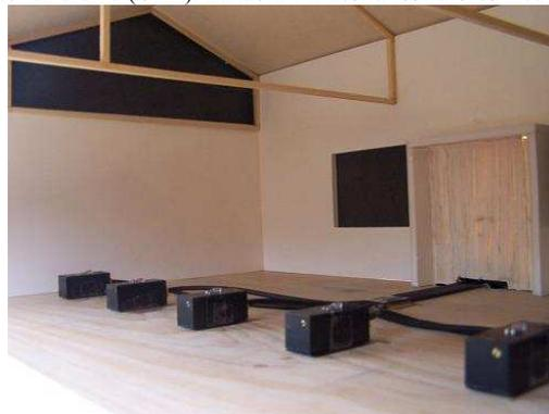
Figura 13 - Interior de maqueta con sensores de medición
